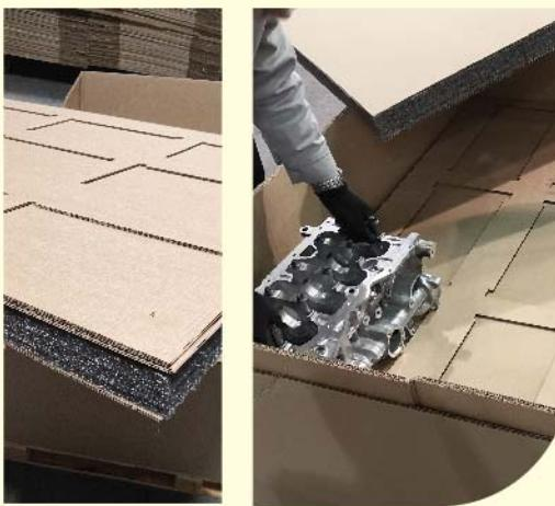
На фото тара для упаковки блока цилиндра. При разработке использовался 2D чертеж детали. Посадочные места подогнаны под фигуру блока, что не позволяет ему смещаться при долгой транспортировке. Сверху блоки фиксируются аналогичным ложементом и укладываются в 2 ряда.
