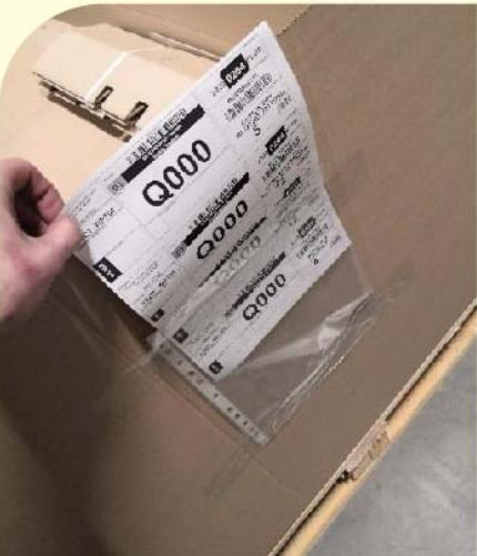
Файл для информационной бирки поставщика. Модуль поступает сразу с приклеенным файлом, оператор сможет вставить в него бирку, что облегчит и ускорит его работу.
