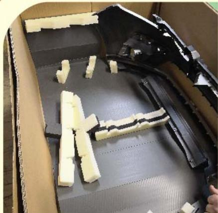
На фото тара для упаковки автомобильного бампера. При разработке использовалась 3D модель бампера. В результате получилась картонно-деревянная тара с использованием сотового полипропилена и изолона (вспененный материал). Эти материалы хорошо зарекомендовали себя при упаковке крашенных деталей.
